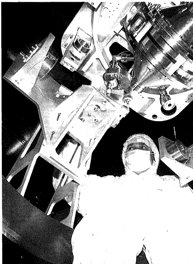
Dall'interno. L'alloggio laser della grande antenna Virgo. FOTO: ANSA
